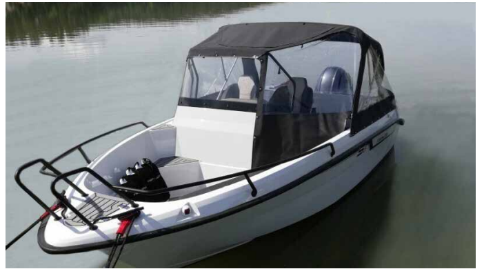
FM331649 Peräkuomu. (lisävaruste). Takaosa ja sivut on irrotettavissa vetoketjujen ansiosta.
