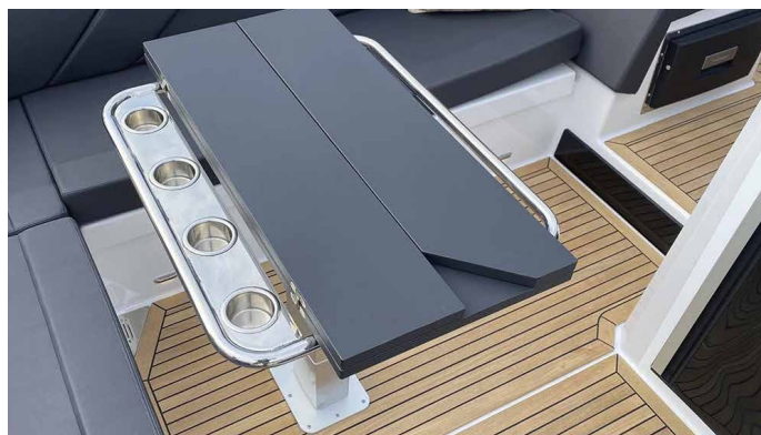
Sähköisen pöydänjalan (vakiovaruste) avulla on helppo muodostaa aurinkotasoa avotilaan.
