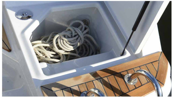
Polttoaineen täyttö sijaitsee ankkuriboksin luukun alla. Kaasujousi pitää luukun avoinna.
