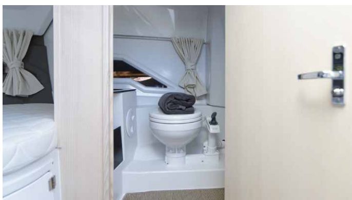
Erillinen WC-tila, jossa pesuallas, runkoikkuna tuuletusventtiilillä ja vesi-WC 47-litran septitankilla.
