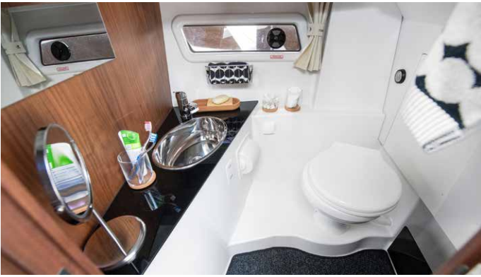
Erillinen WC-tila, jossa pesuallas, vesi-WC sähköisellä huuhtelulla ja runkoikkuna tuuletusventtiilillä.
