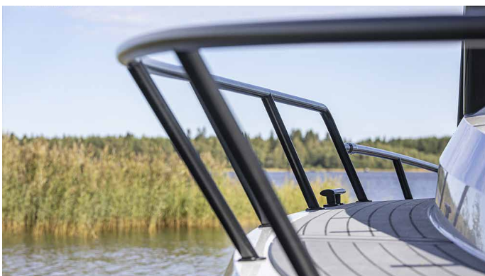
Keulakaiteet ovat korkeat, tukevat ja valmistettu haponkestävästä teräksestä.
