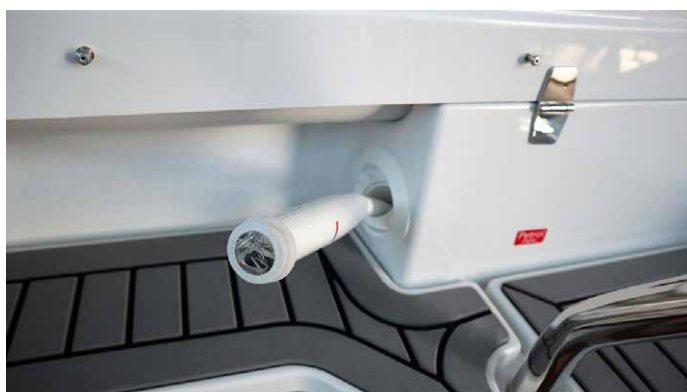
FM331862 Kansisuihku sis. vesitankki 39 litraa (lisävaruste).
