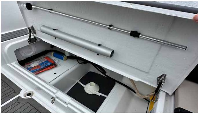
Takapenkin alla on suuri säilytystila. Luukun saa auki patjat paikoillaan ja erikoissaranoiden ansiosta se pysyy avoinna.
