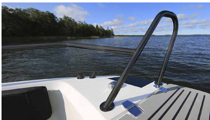
Mustat kaiteet, kahvat ja knaapit on valmistettu haponkestävästä teräksestä.
