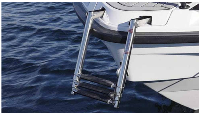
FM331747 Keulaportaat (lisävaruste). Keulaportaat on helppo ottaa käyttöön keulan ankkuriboksista.
